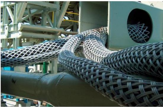
Este es el modelo mas utilizado, se denomina malla de acero Doble Ojo - Boca y es utilizado por todas aquellas maquinas que poseen mangueras neumáticas o hidráulicas de alta presión y que pueden ser foco en caso de corte o falla de accidentes graves a todas aquellas personas que deben permanecer cerca de la maquina una vez que esta entre en funcionamiento. El diámetro y largo de estas mallas pueden ser modificados, llegando a fabricar mallas de los mas diversos diámetros y largos.
